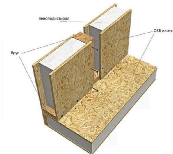
СИП представляет собой панель с сердцевиной из утеплителя, закрытого с обеих сторон ориентированно-стружечными плитами (ОСП)
